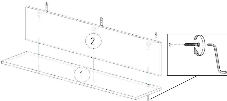
1. Соедините детали 1, 2 с помощью винтов евро 7x50 мм.
